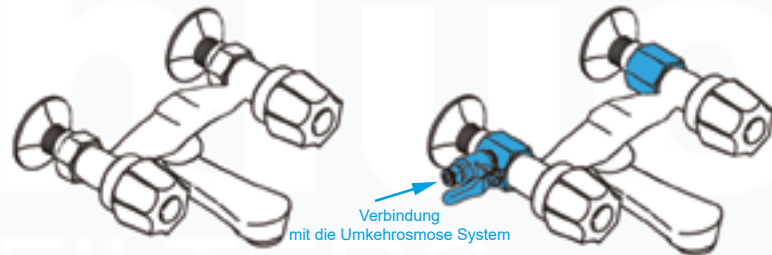
Abb.8- Messingzuleitung 3/4" am Wasserhahn
