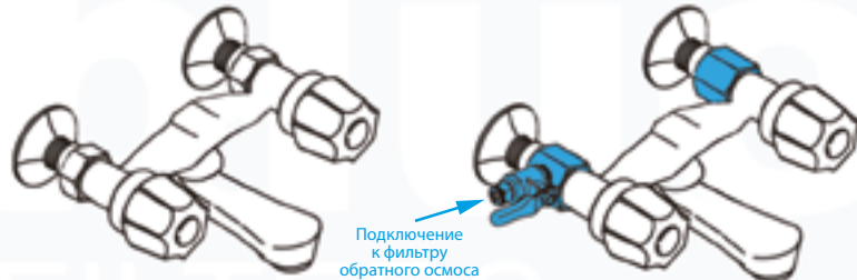
Рис.8 – латунное подключение к водопроводу 3/4" вентиль, способ подключения
