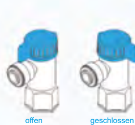
Abb. 12 – Position des Kugelventils am Wassertank
