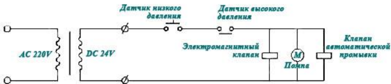
Рис.2 Электрическая схема работы фильтра.
