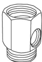
1. **Перехідна муфта** служить для підключення системи до водопроводу. Муфта накручується на трубопровід холодної води  $1\frac{1}{2}''$ , на муфту накручується шланг крана змішувача. В муфті є отвір з різьбою  $1\frac{1}{4}''$ , в який вкручується кран подачі води на систему.
