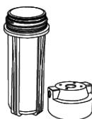
**3. Корпус для картриджів.** В системі передбачено три таких корпуси, з'єднаних послідовно муфтами. Корпус складається з двох частин: оголовка та колби, виготовлені з пластику. Для установки та\або заміни картриджів необхідно відкрутити колбу за допомогою монтажного ключа.
