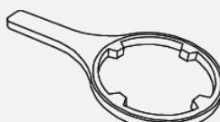
**16. Монтажний ключ** – застосовується при встановленні та\або заміні картриджів попереднього очищення. При заміні картриджів колби відкручуються проти годинникової стрілки, а закручуються – за годинниковою. При закручуванні колби не слід докладати надмірних зусиль.
