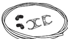
**17. Трубки, фітинги, скоби, кліпси.** Всі вузли системи зворотного осмосу, перераховані вище, з'єднуються між собою пластиковими гнучкими трубками діаметром 1\4". Для підключення трубок у системі застосовуються фітинги, які оснащені кліpsами для запобігання випадкового від'єднання трубки. Скоби служать для кріplення елементів на монтажній пластині та між собою.
